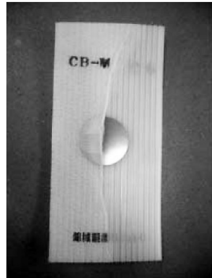
図-5 被感知材付ドレーン材
