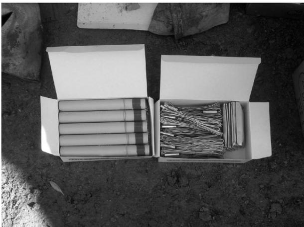
図-3 低振動破碎薬剂（ガンサイザー）
