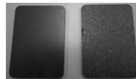
表-5に内面被覆（ジックライトD工法：J Eシート）の引張試験強度一覧を示す。規格値1.5 N/mm<sup>2</sup>以上に対して3.4N/mm<sup>2</sup>の値が得られており、被覆接着性の向上していることが確認された。
