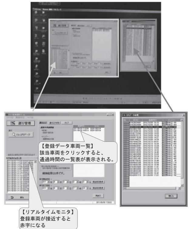
図-6 ETC 車両運行管理システムモニター
