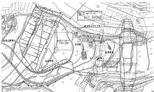
図-2 INSEM 施工ヤード計画図
