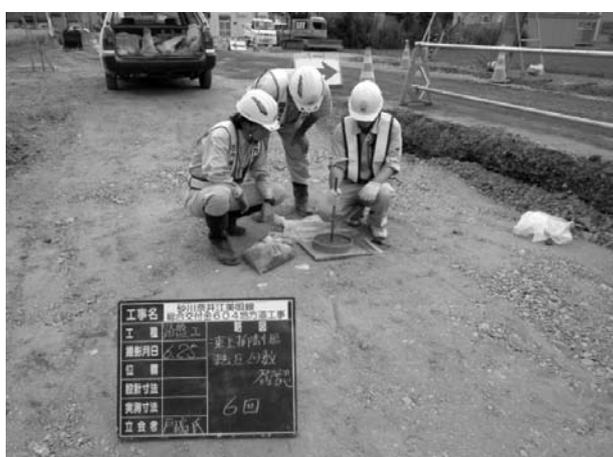
図-7 試験転圧密度試験
