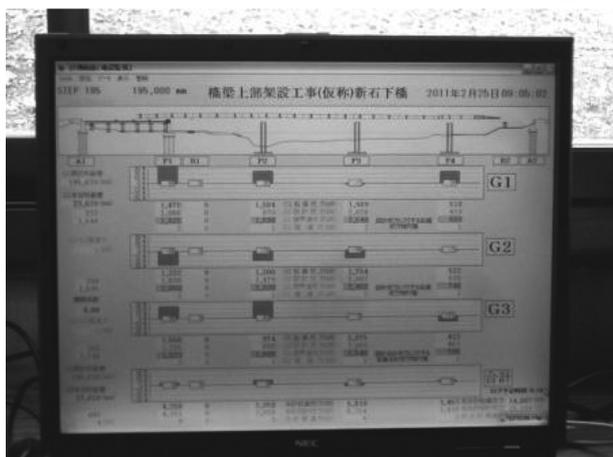
図-6 反力管理状況と反力表示画面
