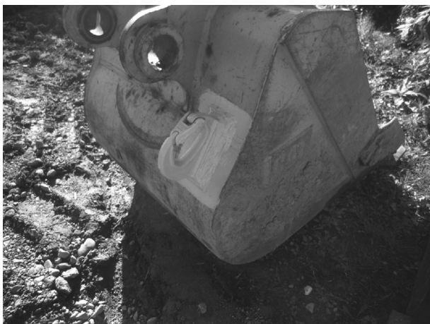
図-8 JIS規格フックを溶接
