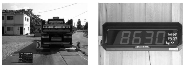
図-2 ロードメーターによる積載重量確認
