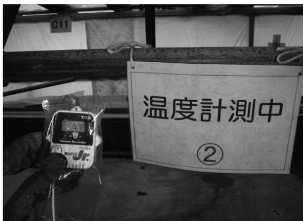
図-8 データロガー式温度計
