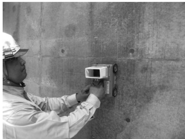
図-3 鉄筋探査状況(電磁波レーダ法)
