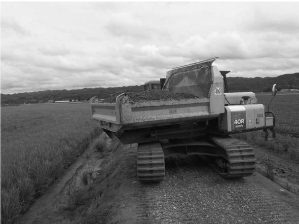
図-6 全回転型不整地運搬車
