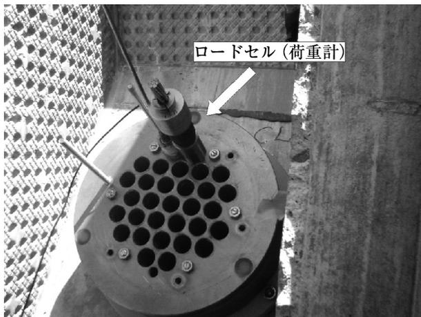
図-5 ロードセル設置状況
