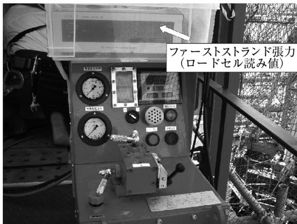
図-6 ロードセル測定値表示状況
