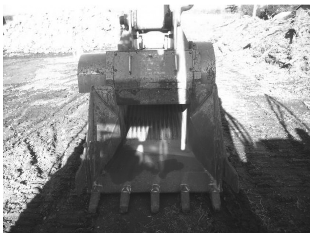
図-2 バケット式再生骨材製造機
