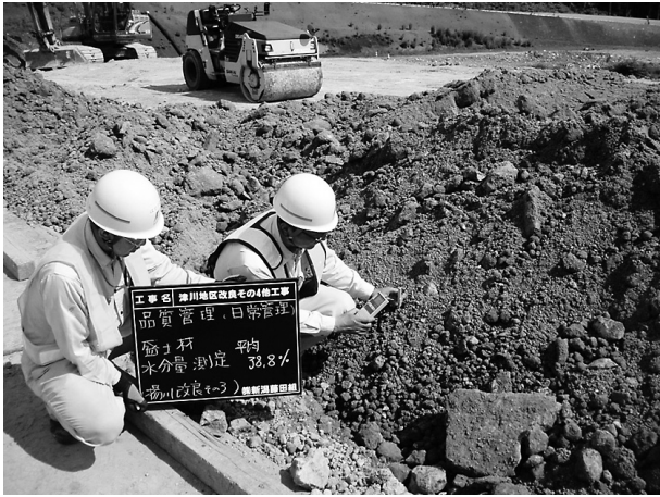
図-1 簡易水分計による含水比測定
