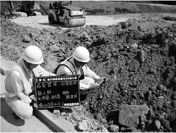
図-1 簡易水分計による含水比測定
