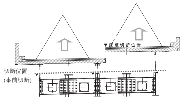
図-10 既設床版の分割撤去
