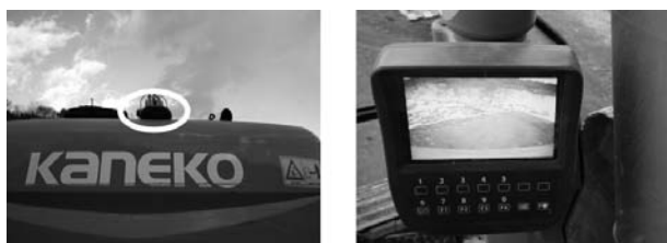
図-9 バックカメラ搭載型のパワーショベル
