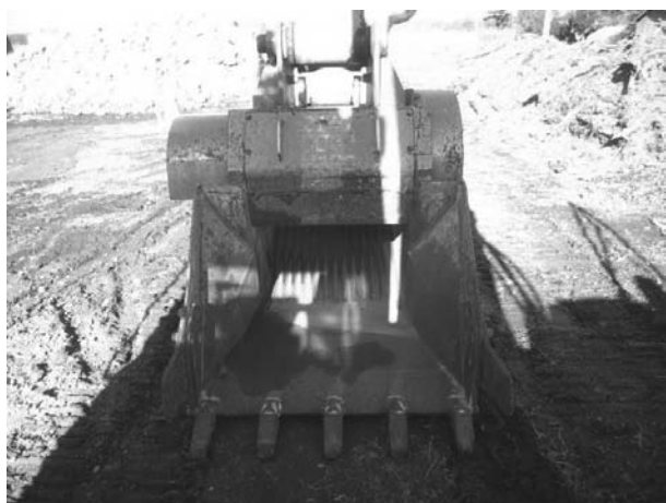
図-2 バケット式再生骨材製造機
