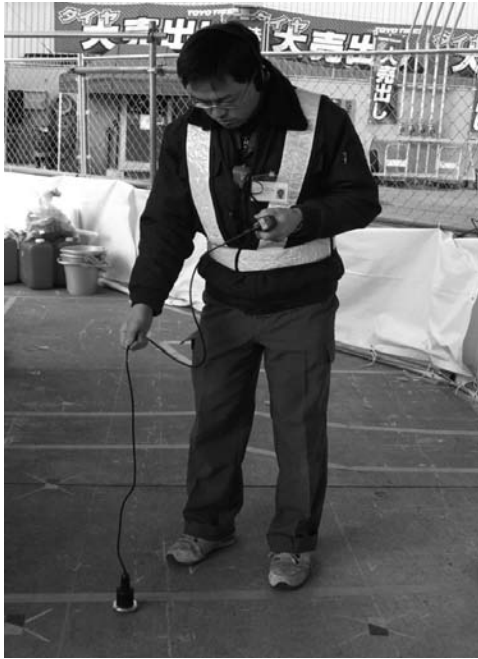
図-7 漏水探知器
