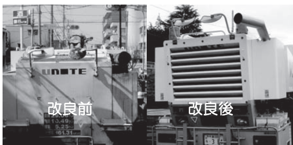
図-3.2.2 切削機排気ガス排出向きの変更
