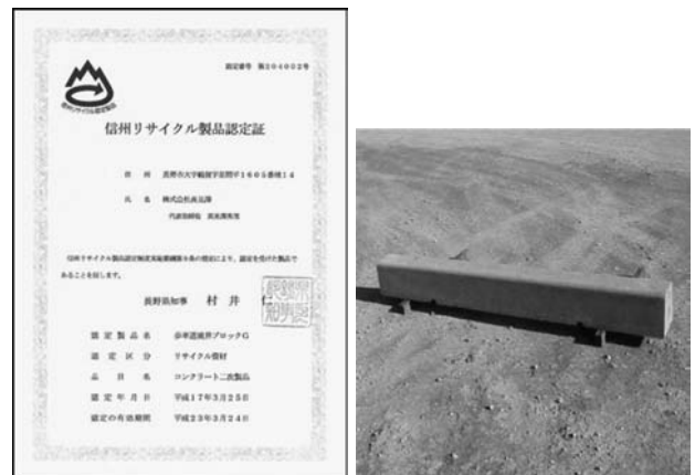
図-6 ガラスカレット骨材使用したリサイクル二次製品
