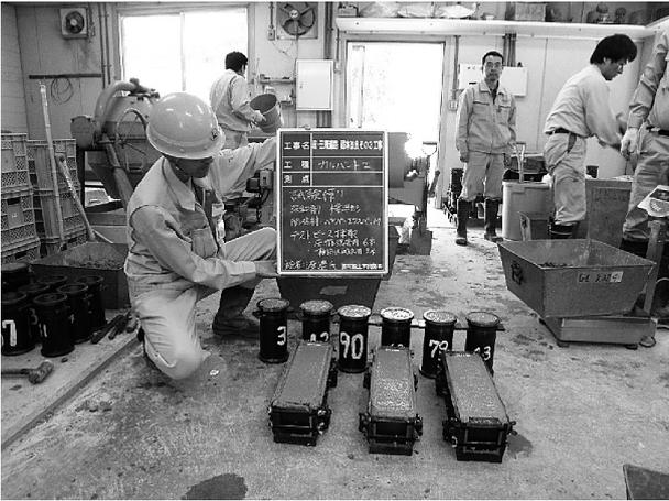
図-2 試験練り状況（手前が拘束膨張試験用供試体）
