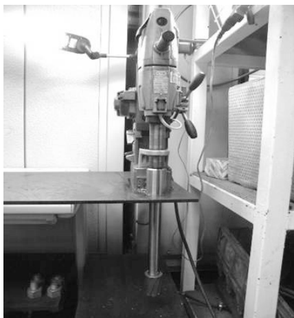
図-9 削孔機械試験状況
