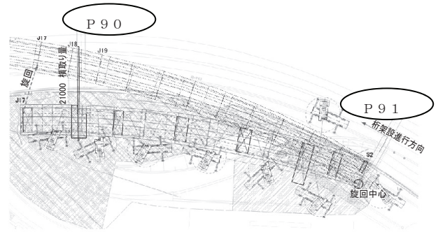
図-3 作業ヤード内桁組立要領図
