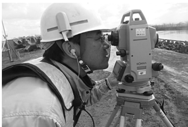
図-4 距離と方向を光波で確認し無線で指示
