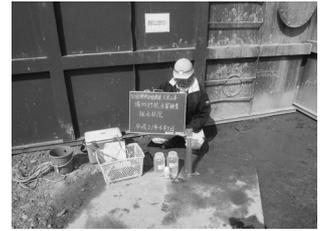
図-2 場所打ち杭施工後水質調査
