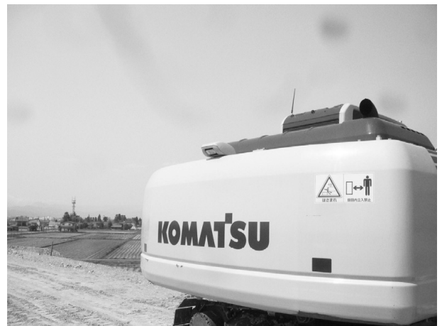
図-1 後方確認モニター設置状況
