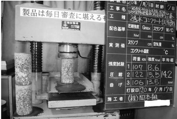
図-2 透水コンクリート強度試験
