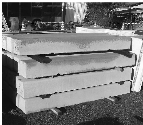
図-6 ガラスカレット骨材使用したリサイクル二次製品
