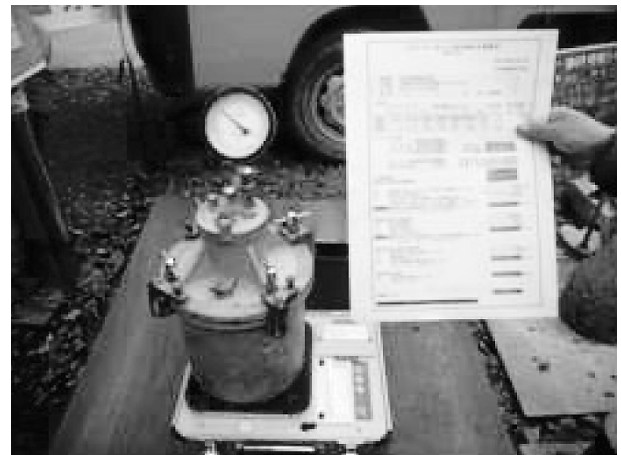
図-2 単位水量測定状況 (エアメータ法)
