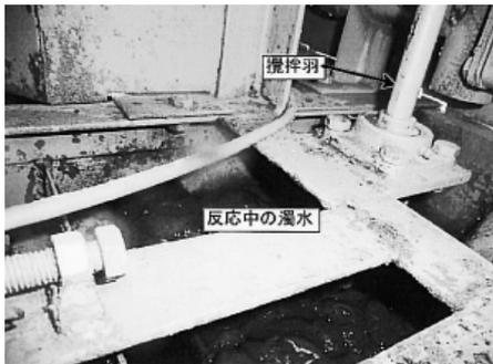
写真-4 攪拌槽内部
