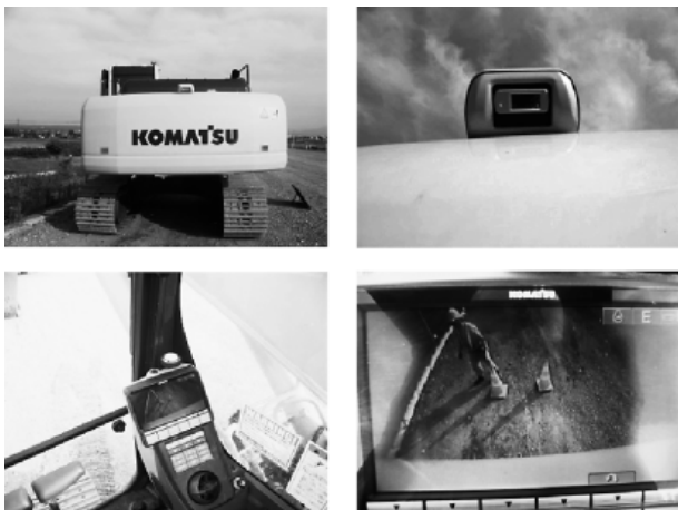
写真-1 バックモニター付バックホウ (左上：全景、右上：監視カメラ拡大、 左下：室内モニター、右下：モニター拡大)
