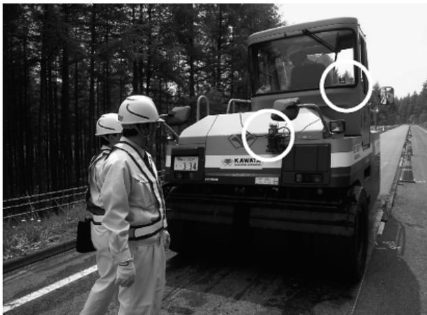
写真-2 センサー作動確認
