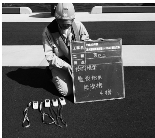
写真-6 監視船専用無線機
