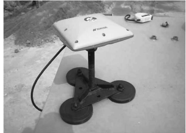
写真-4 GNSS アンテナ
