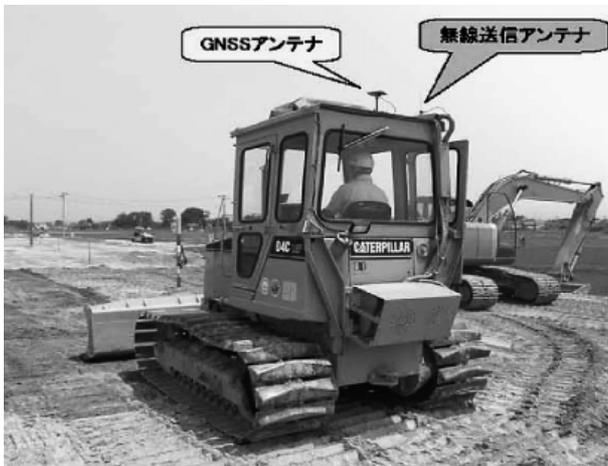
写真-3 GNSS 及び無線送信アンテナ設置
