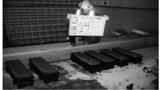
写真-6 曲げ強度試験 供試体作製
