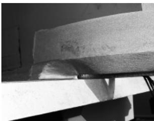
写真-2 ノンスカラップ開先端部の船底型整形
