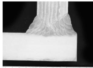
写真-4 ノンスカラップ部の断面マクロ
