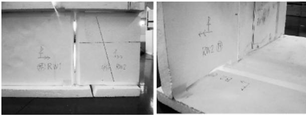
写真-1 Z継手の施工性確認模型
