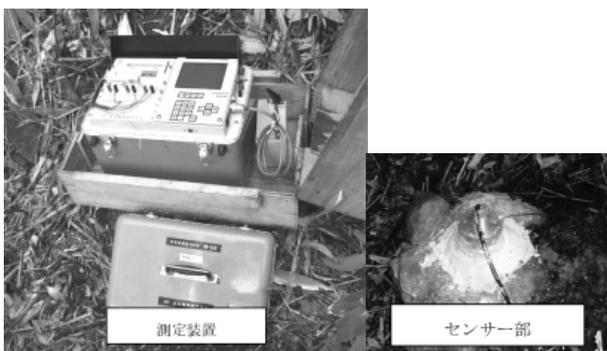
写真-3 発破振動監視装置（GW-300）
