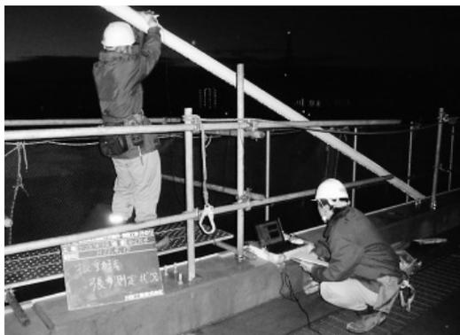
写真-2 振動法による計測状況
