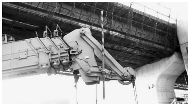
写真-1 近接確認装置装着状況
