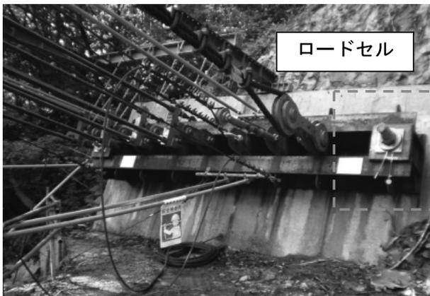
写真-5 ロードセル設置状況（アンカー設備全景）
