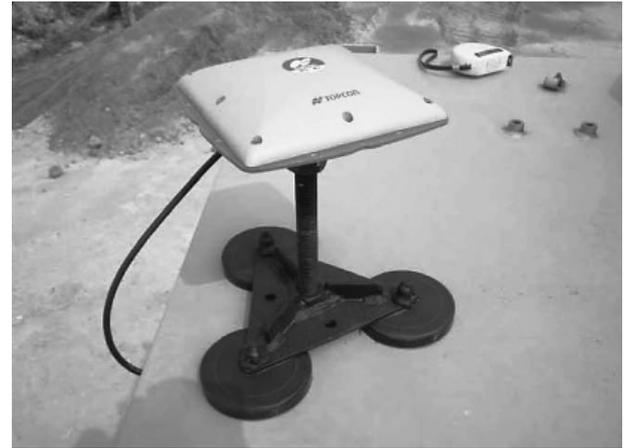
写真-4 GNSS アンテナ
