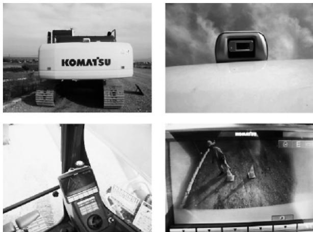
写真-1 バックモニター付バックホウ
