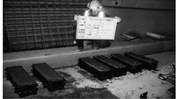
写真-6 曲げ強度試験 供試体作製
