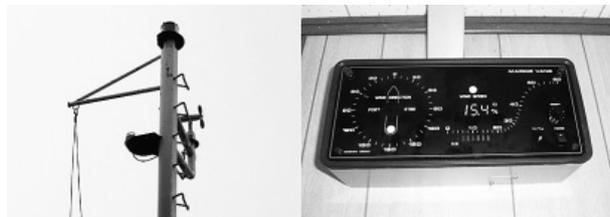
写真-2 外部設置風速計とデジタル表示部
