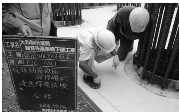
写真-9 浸透探傷試験
