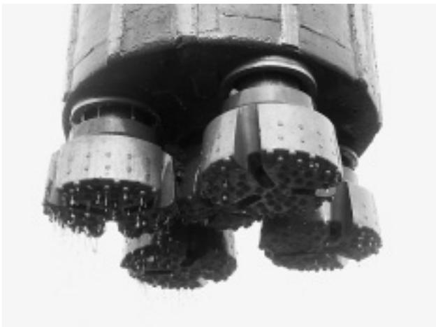
写真-2 マルチドライバー先端部
