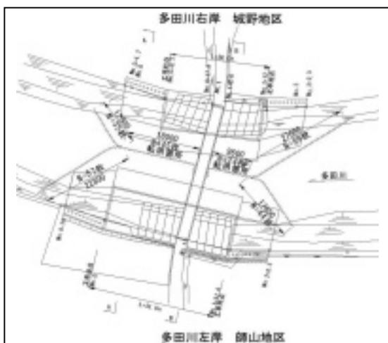
図-3 仮設鋼矢板転用打込み平面図
