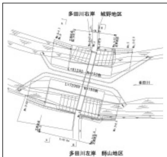
図-2 当初仮設鋼矢板打込み平面図
