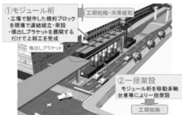
図-5 すいすいMOP工法
