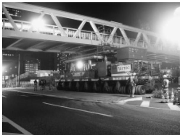
写真-4 多軸式特殊台車（9軸）
