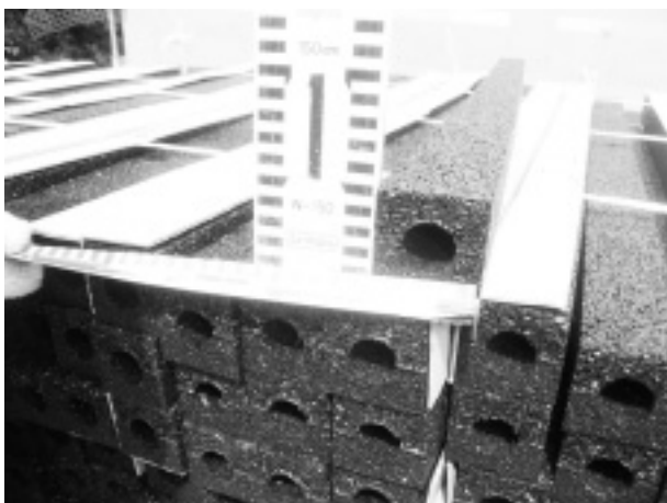
写真-1 排水性舗装用ゴムチップ導水管
