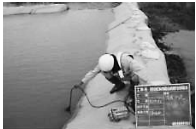
写真-7 濁度測定状況
