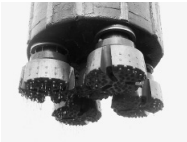
写真-2 マルチドライバー先端部
