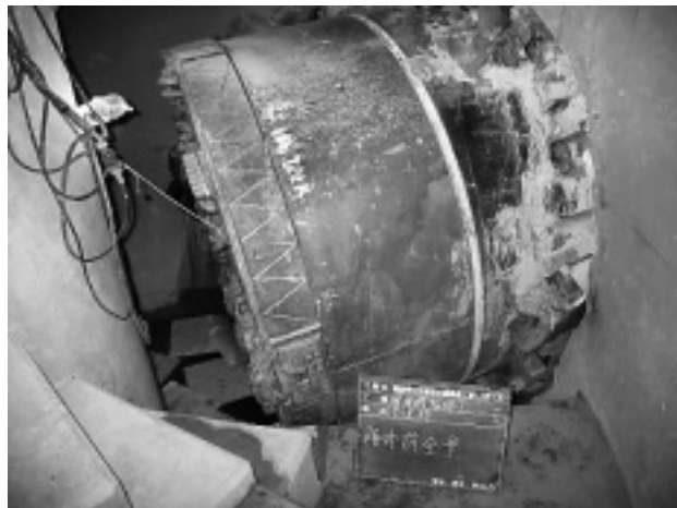
写真-3 掘進機解体前
