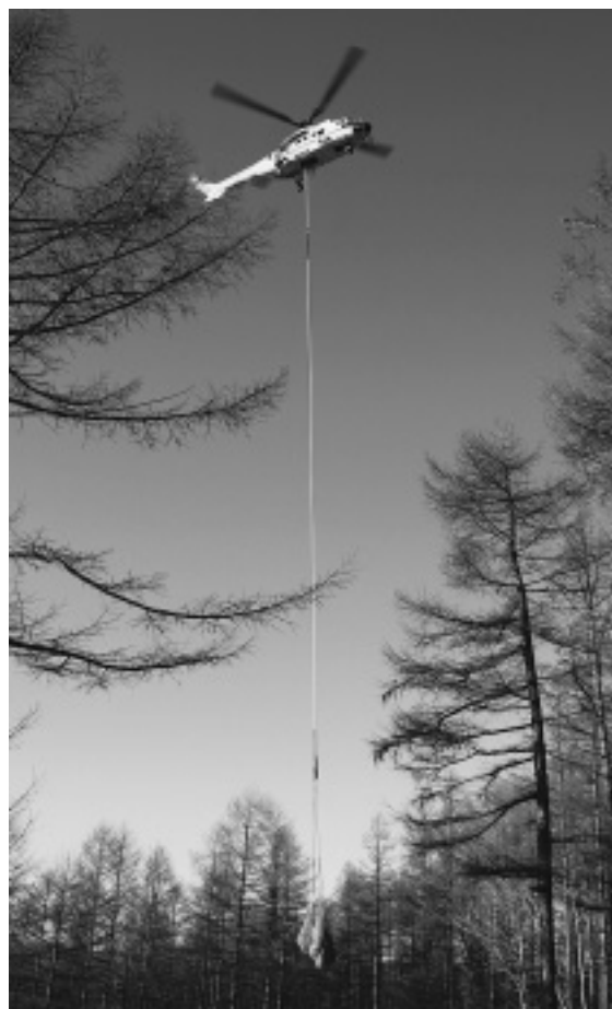
写真-2 カーゴスリング40m長吊り
