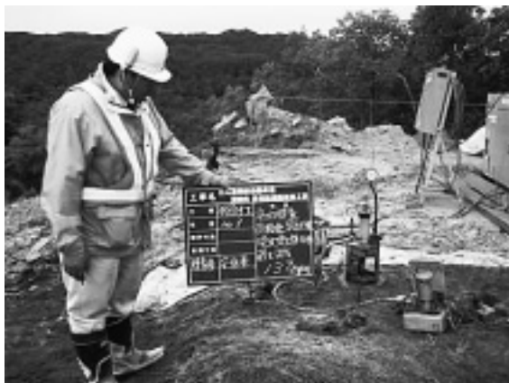
写真-1 引抜抵抗力試験
