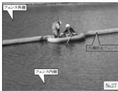
写真-7 異常発生時の水質調査状況
