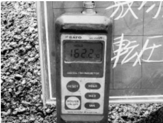
写真-2 現場到着温度状況 (接写)
