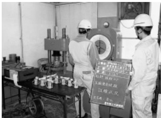
写真-4 抜き取りコアの圧縮強度、ヤング係数測定試験
