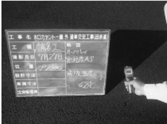
写真-6 レーザー温度計による計測
