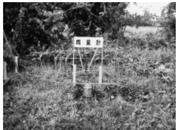
写真-7 雨量計設置状況
