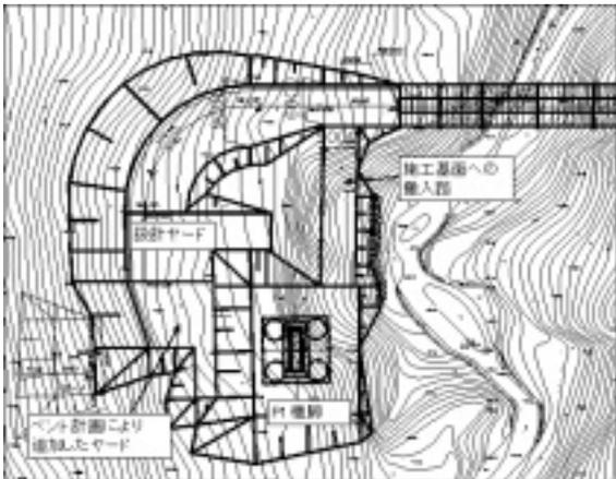
図-3 施工ヤード計画図
