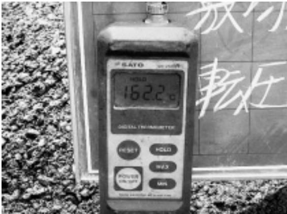
写真-2 現場到着温度状況 (接写)
