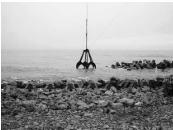
写真-4 オレンジピールバケツによる搜索状況
