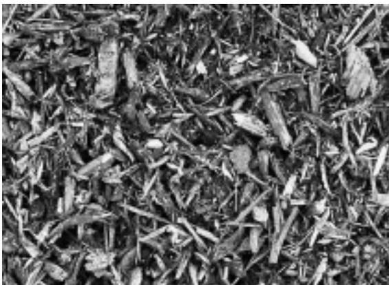
写真-5 通常1次破碎チップ規格38mm以下
