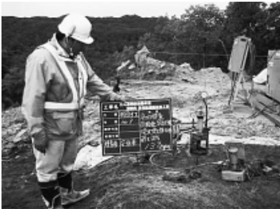
写真-1 引抜抵抗力試験
