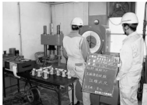
写真-4 抜き取りコアの圧縮強度、ヤング係数測定試験
