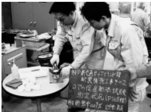
写真-6 抜き取りコアの残存膨張量
