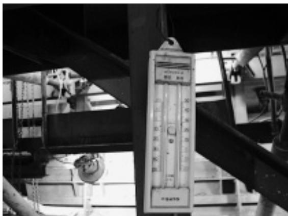
写真-5 養生温度
