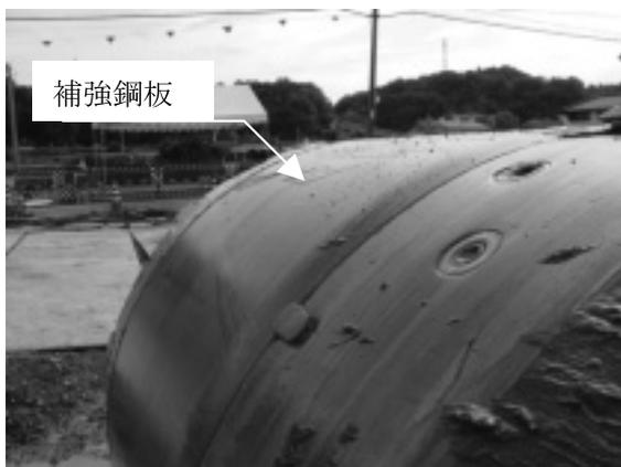
写真-2 先端部の改良(補強鋼板)
