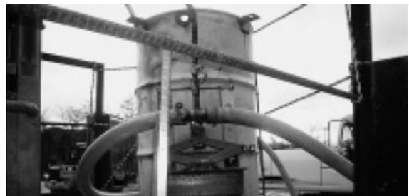
写真-1 混合水計量装置
