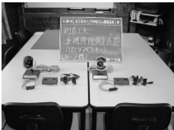
写真-1 重機接触防止装置
