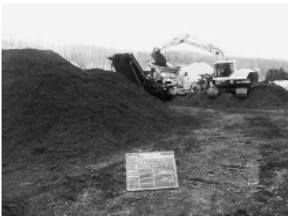
写真-4 チップの2次破碎作業
