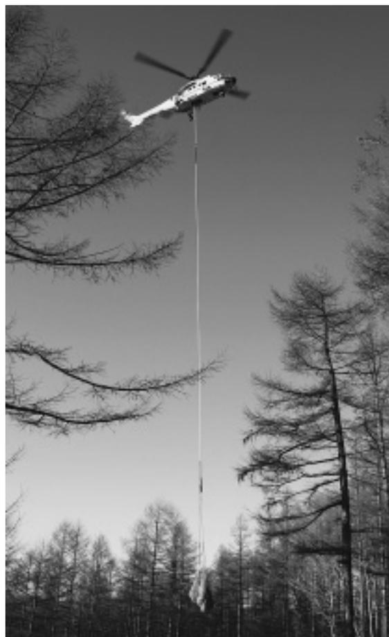
写真-2 カーゴスリング40m長吊り
