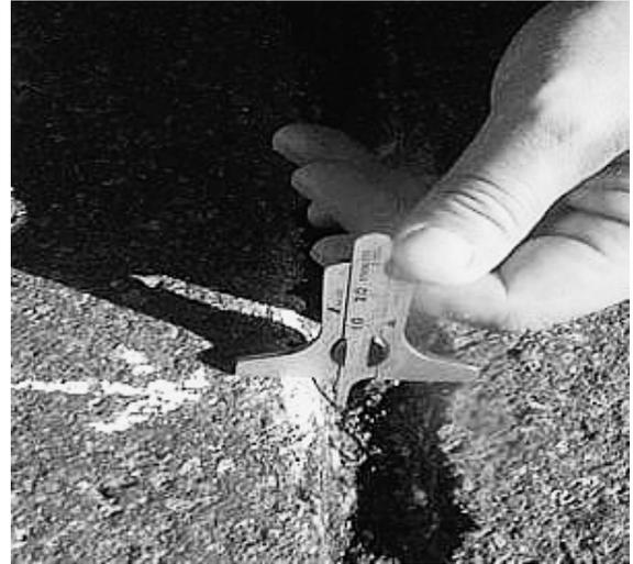
写真-10 深さ設計：10mm 実測：11mm
