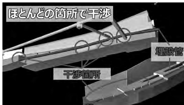
図－1 埋設管と干渉する新設構造物
