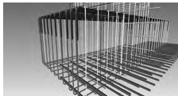
図-3 CIM活用(配筋照査)
