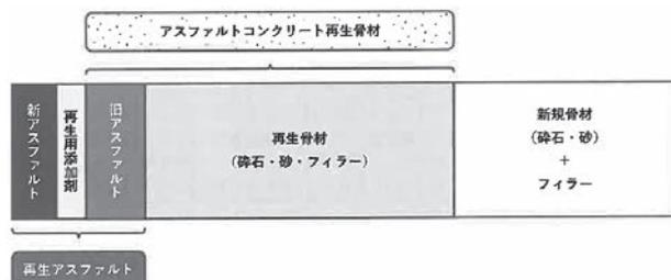
図-4 再生混合物の素材の概念<sup>3)</sup>
