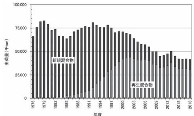
図-6 再生混合物の出荷量の推移<sup>1)</sup>
