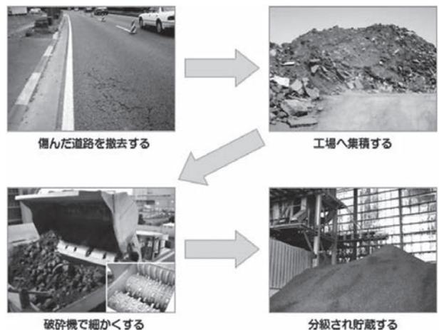
図-2 再生骨材の製造プロセス<sup>2)</sup>
