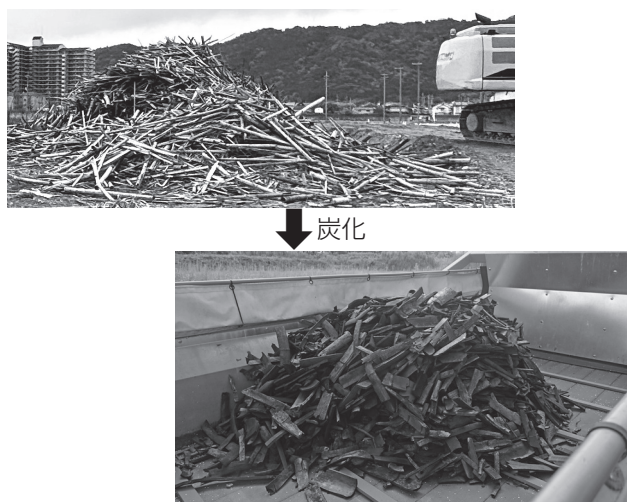
図-3 放置竹を伐採して得た材（上）と炭化して生成されたバイオ炭（下）
