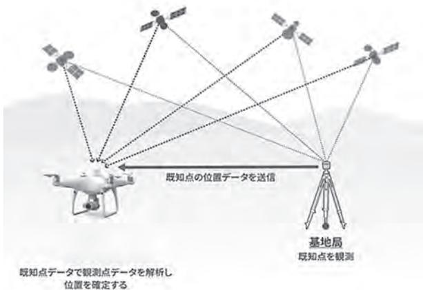
図-8 RTK-GNSS方式のイメージ
