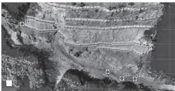
図-9 安全な箇所での検証点設置
